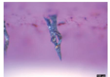
Aus Druckfarbe ausgesiebter Metallsplitter mit gratigem, stengelförmigem Aussehen (Länge 0,8 Millimeter).
